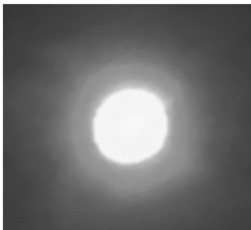
图4 589 nm 激光远场光斑照片
